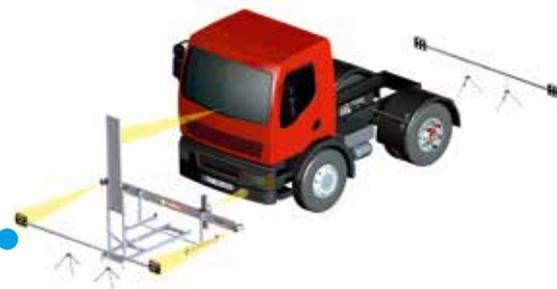
La barra horizontal de medición y el reflector de calibración se alinean a una distancia exacta delante del vehículo según marca y modelo
