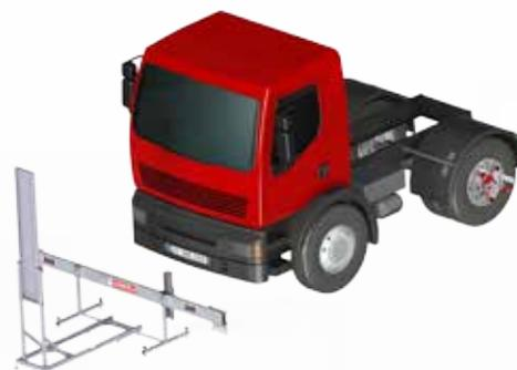
La traversa di misurazione e il riflettore di calibrazione sono allineati orizzontalmente ad una distanza esatta davanti al veicolo.
