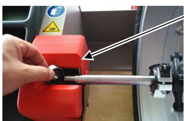
Затем из BikeBoss вынимается колесно-вальный блок и подвешивается колесом на телескопической штанге. (рис. 53)
