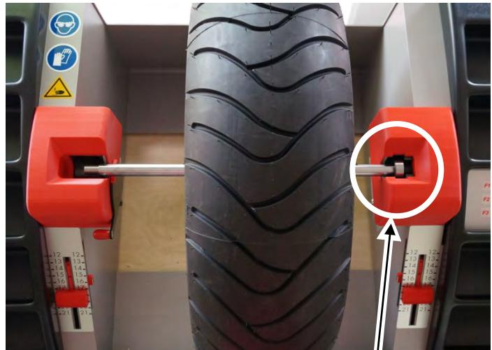
С левой стороны вал располагается на рычаге опускания вала. Таким образом в опорном кронштейне на конец вала может быть установлен плавающий шарикоподшипник. (рис. 27)
