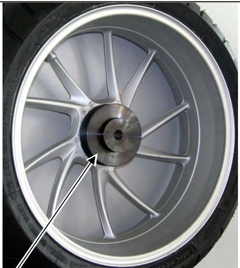
Установка соответствующего центрирующего диска
